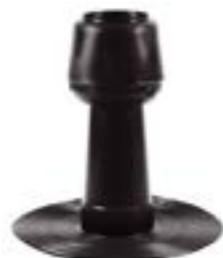
Аэраторы кровельные ТЕХНОНИКОЛЬ 160 x 460 мм и ТЕХНОНИКОЛЬ ЭКО 160 x 450 мм позволяют эффективно удалять излишки влаги из кровельного пирога. Монтаж аэраторов при устройстве или ремонте совмещенной кровли дополнительно увеличивает эффективность минераловатной теплоизоляции, за счет снижения ее влажности.
