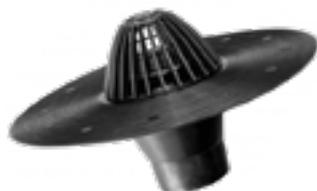
Воронки ТЕХНОНИКОЛЬ ВБ предназначены для установки в кровли, выполняемые из битумных и битумно-полимерных материалов. Верхняя часть воронки с мелким оребрением вплавляется в разогретую битумно-полимерную смесь или горячую мастику между слоями кровельного материала.
