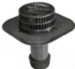
Воронка изготавливается из смеси полимеров, обеспечивающих стойкость к эксплуатационным нагрузкам в течении 15 лет. Верхняя часть ремонтной воронки с профилированной поверхностью должна вплавляться между слоями кровельного ковра с помощью пропановых горелок.
