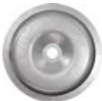
Круглый тарельчатый держатель диаметром 50 мм из оцинкованной стали. Применяется для механической фиксации на горизонтальной поверхности кровельных материалов Техноэласт ФИКС ЭМП и Техноэласт СОЛО РП1 ЭКВ к основанию из цементно-песчаной стяжки или монолитной бетонной плиты.
