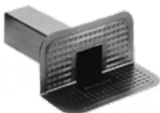
Итальянская воронка для отвода воды через кровельные или балконные парапеты. Изготовлена из огнестойкого термопластичного эластомера (ТРЕ). Имеет широкий фланец и усиленную полку. Радиус изгиба 90°. Рельефная поверхность позволяет легко наплавлять битумные мембраны.
